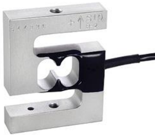
Figura 4.7: Célula de carga ALFA S-5 (5)
